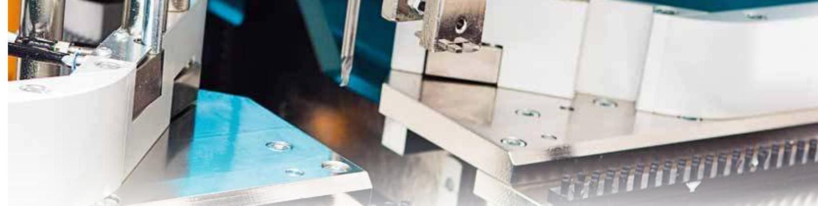
90°açı ile kaynatılmış PVC profillerin, kaynak sonrası oluşan çapaklarını temizleyen CNC kontrollü çapak alma makinesidir.
